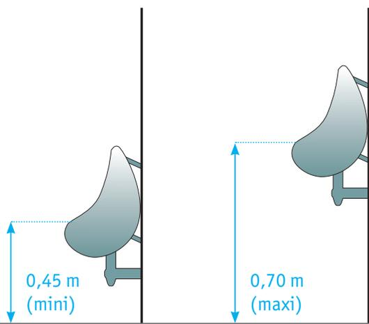
Les urinoirs en batterie doivent être disposés à des hauteurs différentes. La hauteur de mise en oeuvre des urinoirs est fonction des utilisateurs.
