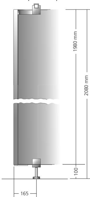
5 Raccordement au mur avec un joint creux
