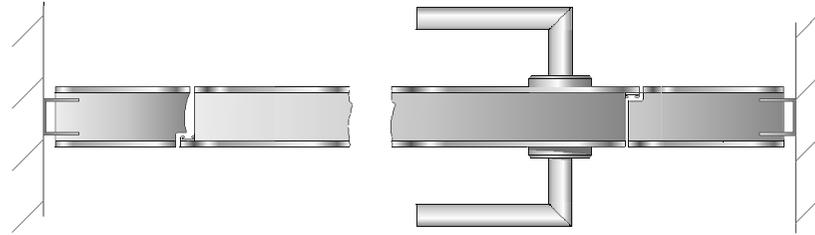
3 Raccordement de la façade à la cloison
