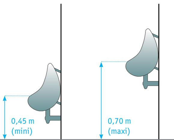
Les urinoirs en batterie doivent être disposés à des hauteurs différentes. La hauteur de mise en oeuvre des urinoirs est fonction des utilisateurs.
