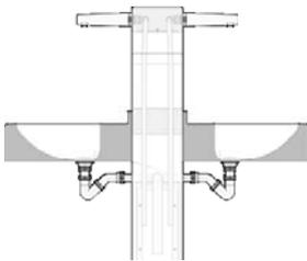
Pour ces lavabos multipostes sur pied, vous avez le choix d'installer des plans vasques inox avec des vasques en forme de O ou de D, des plans vasques Akzept, Quadro ; Ovalo, Rondo en béton polymère. La structure autoportante reste toujours en acier inoxydable.
